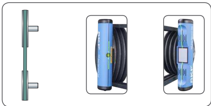
Рисунок 9 Соосность шкивов после правильно выполненной выверки
