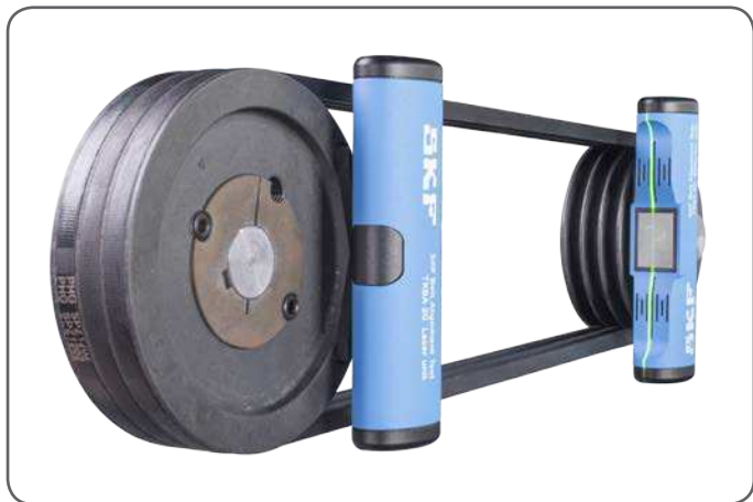
Figure 4 Unités montées sur poulies
