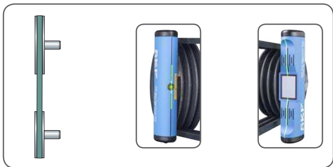
Figure 9 Poulies parfaitement alignées
