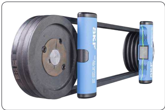
Imagen 4 Unidades montadas en poleas
