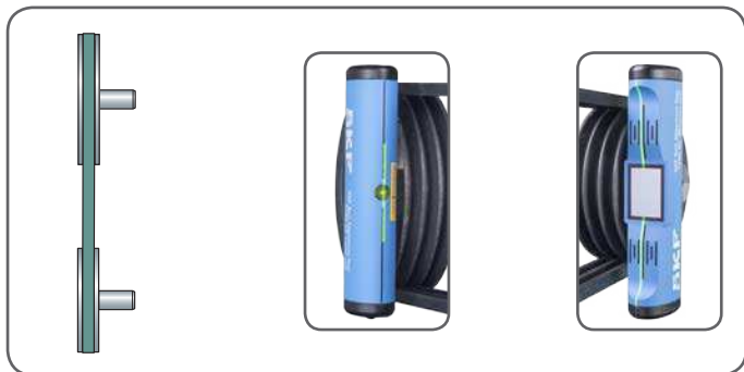
Abbildung 9 Perfekt ausgerichtete Riemenscheiben
