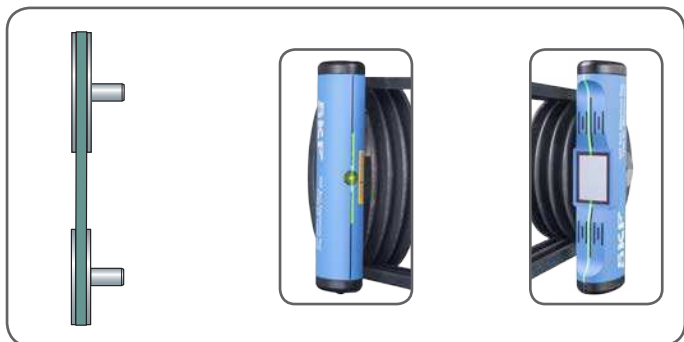
Figura 9 Polias perfeitamente alinhadas
